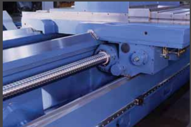
Detalle de husillo estático a bolas con tuerca giratoria.
