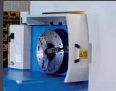
Detalle de cabezal con gran paso de barra y plato automático trasero.
