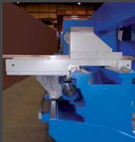
Detalle bancada con tercera guía de apoyo para el carro y guías prismáticas en "V" invertida.
