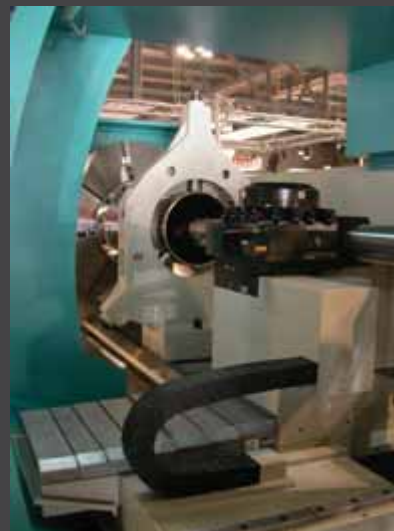
Detalle de mecanizado de pieza de gran dimensión con operaciones de mandrinado y taladrado.
